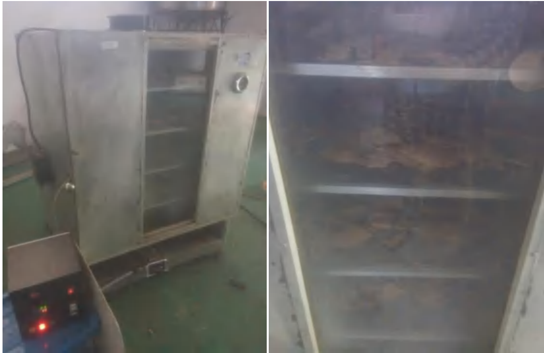
Gambar 11. Uji coba alat pengeringan/ Dryer
