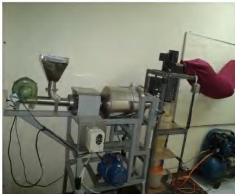
Gambar 23. Alat penepung sistem kontinyus (Hermanto et al., 2019).
