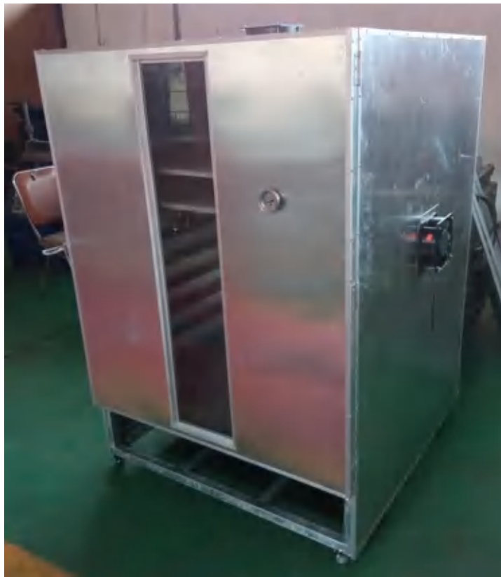
Gambar 9. Hasil perakitan mesin pengering/ dryer
