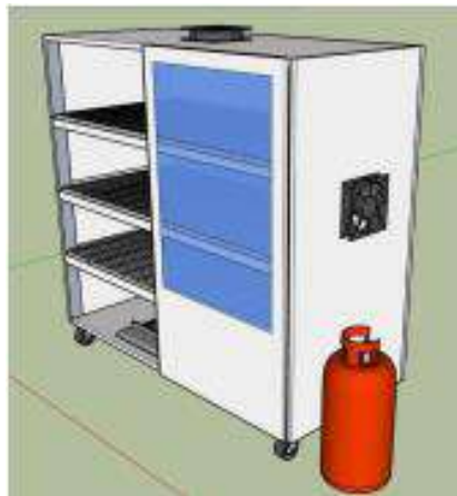
Desain alat pengering/ oven pengering umbi porang
